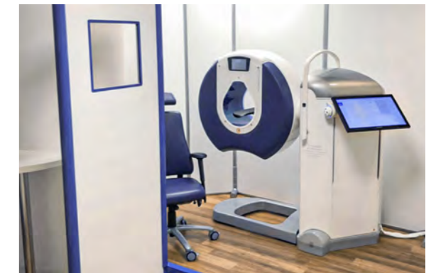
In temporär verfügbaren Räumen: Mobile Strahlenschutzwände schirmen die umgebenden Räume normgerecht ab.
